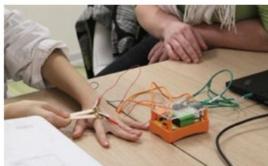
Ces deux électrodes d'électromyographie mesurent l'activité électrique des muscles
